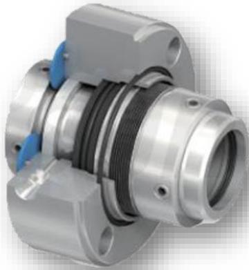
Sello mecánico de fuelle mecánico balanceado de configuración sencilla. El RS-60B ofrece una confiabilidad excepcional en ambientes corrosivos y no corrosivos, especialmente trabajando con fluidos con tendencia a la cristalización en condiciones atmosféricas. El sello RS-60B cumple con los requerimientos API 682 Tipo B.
