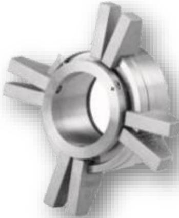
Su diseño único de rotatoria y estacionaria montadas en cartucho hacen muy fácil su instalación. Todos sus o´rings son estáticos y sus resortes se encuentran fuera del fluido. Con caras balanceadas hidráulicamente, anillo de sujeción autocentable y cintilla para medida de operación. Cuenta con la opción de instalación con Brida A.I. 316 D-78 o alteas para instalación universal.
